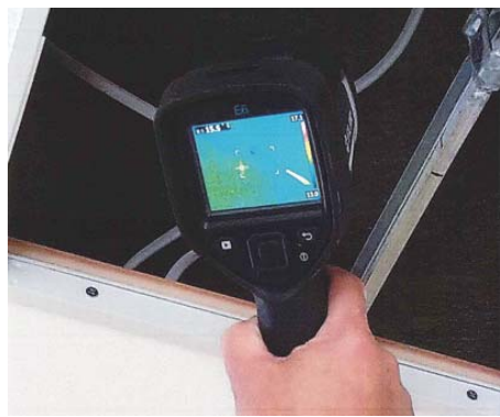
外壁診断の赤外線画像(上)と赤外線カメラでの雨漏れ診断の様子
